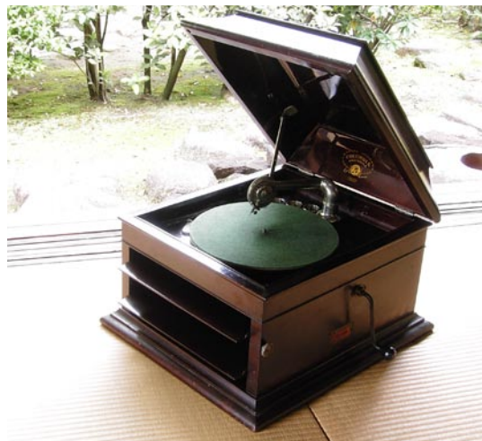
ちくおんき [蓄音機] コロムビア製 90年前 針がレコードの溝からちいさなでこぼこをよみとって振動板につたえ、さらに振動を音にかえてホーンからおおきな音をだします。
