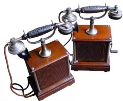
でんわき [電話機] 日本電気社製 90年前 昔の電話は交換手をと おして、相手の電話をよ びだしてもらうしくみ になっていましたので、 ダイヤルやプッシュボ タンはありません。
